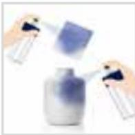
Dose beim Sprühlackieren senkrecht halten. Durch Probessprühen Verträglichkeit und Farbton prüfen. Auf ein gleichmäßiges Lackiertempo und gleichen Sprühabstand achten.
