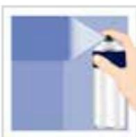
In mehreren gleichmäßigen dünnen Schichten lackieren, z.B. erst horizontal dann vertikal. Einen dünnen Spritzgang vorlackieren, nach 3-5 Minuten in mehreren dünnen Schichten endlackieren.
